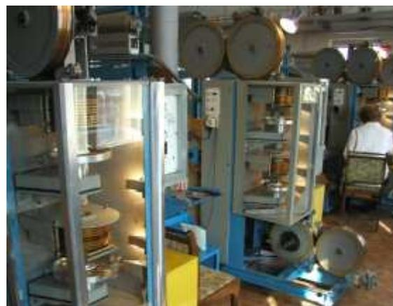
Компания "Алмаз" выпускает обмоточный провод с пленочной запеченной изоляцией марки ППИ-У, используемый в производстве двигателей.
